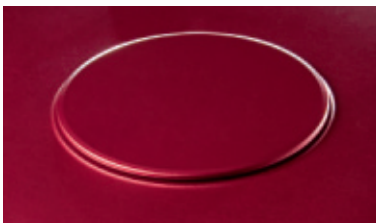
Verdeckter Lufteinlass zum Schutz vor mechanischen Schäden
